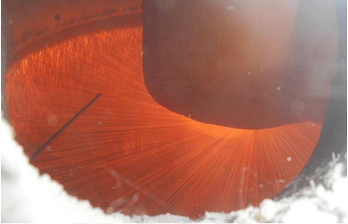
Resim 2.6. Döner plaka üzerinden kuru cüruf granülasyonu [29]
