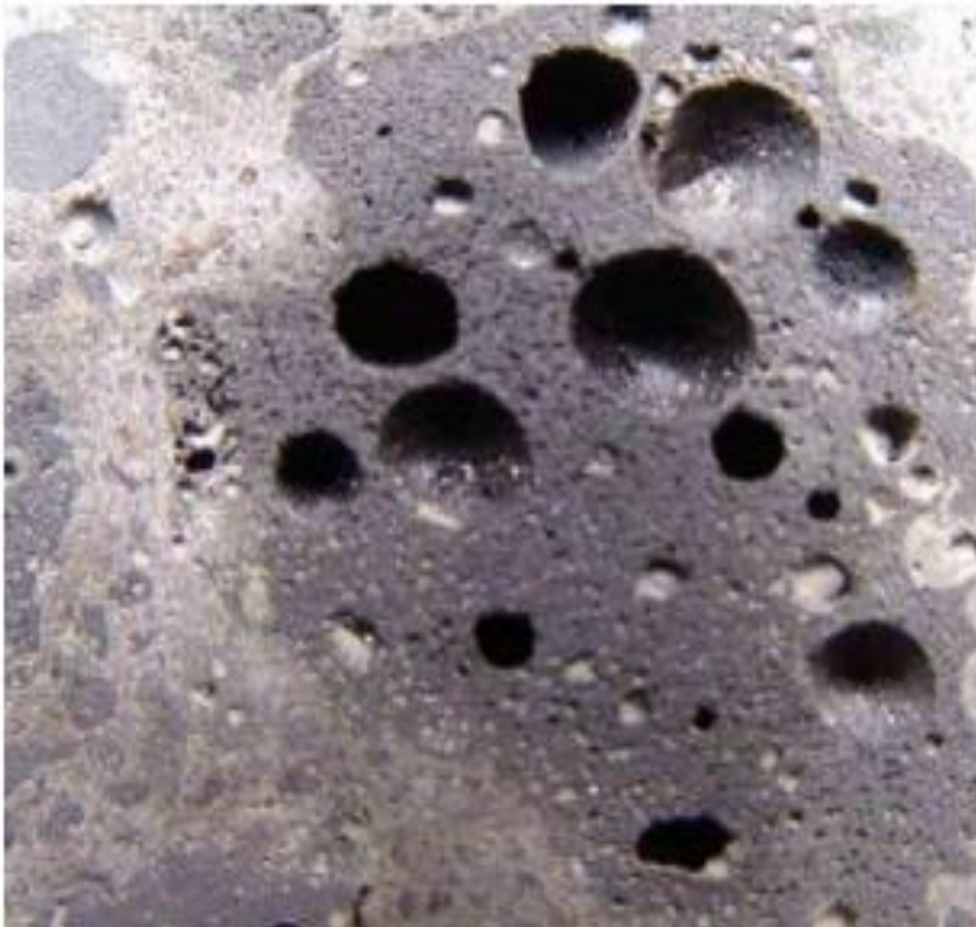
Resim 2.5. Yüksek fırın cürufunun boşluk yapısı [26]
