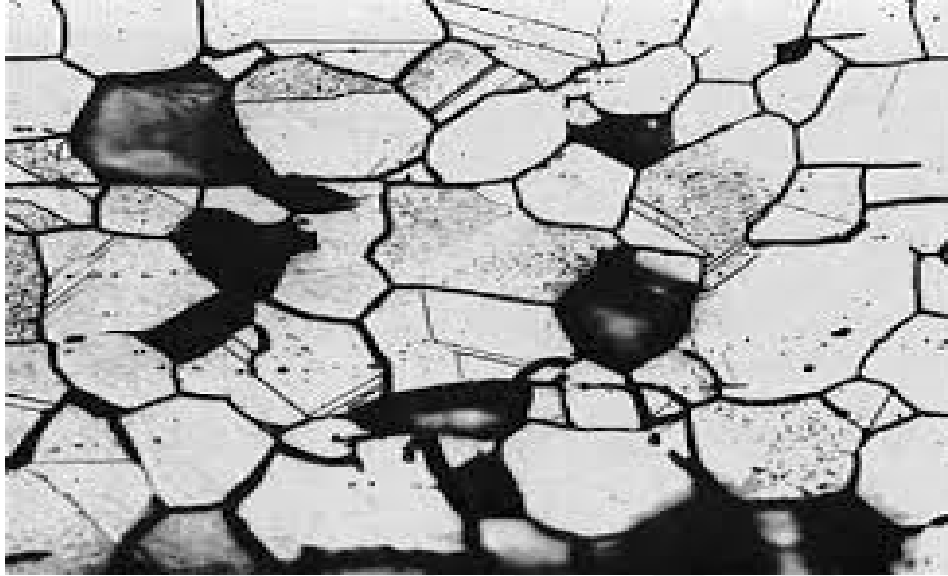
Şekil 2. 3. Paslanmaz çeliğin tane sınırlarında meydana gelen karbür çökmesi (Oğuz, 2018)
