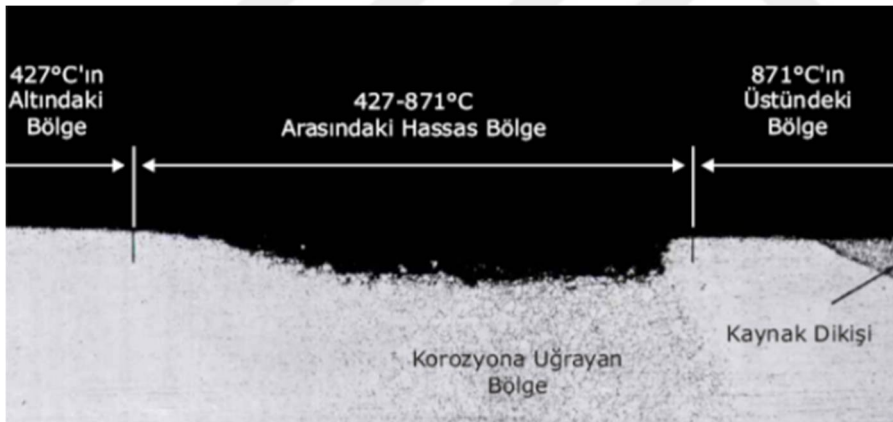
Şekil 2. 4. Krom karbür çökmesi sonucu hassas bölgede meydana gelen korozyon (ASM International, 1998)
