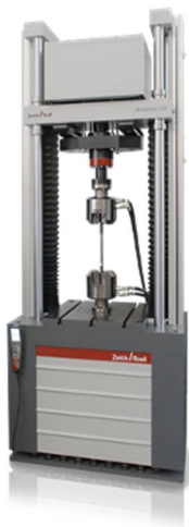
Şekil 4. 15. Zwick/Roel Z600 test makinası (Casalino, Michele ve Perulli, 2020).
