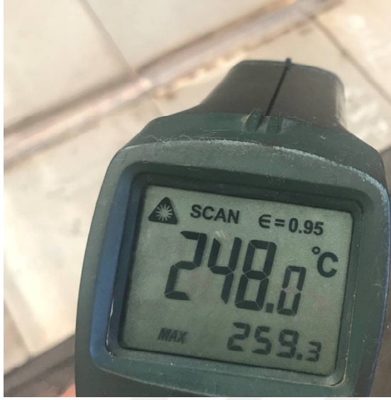
Şekil 4. 12. Lazer termometre ile sıcaklık ölçme
