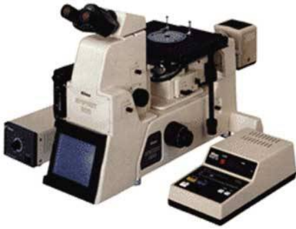
Şekil 4. 18. Nikon EIPHOT 200 optik mikroskop (Anonim, 2019)
