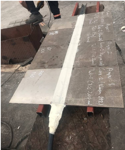
Şekil 4. 4. Kaynağı tamamlanmış tanımlamalı levha
