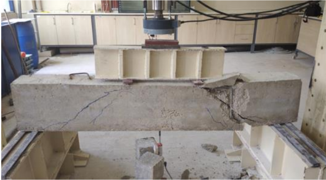
Şekil 4.1. DYNØ8’in göçmüş hali
