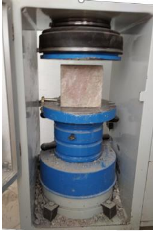
Şekil 3.1. Beton pres makinasında beton testi
