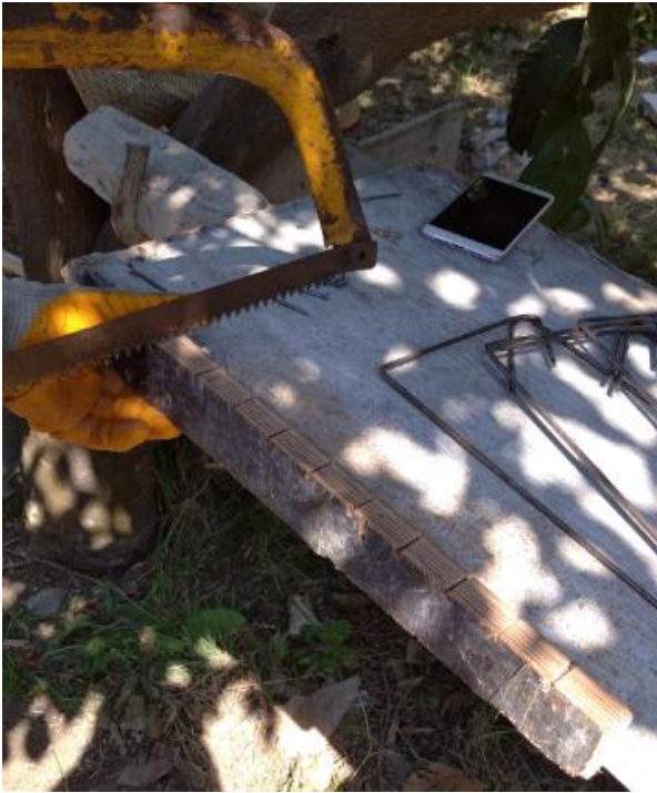
Şekil 3.10. DYNØ4 etriye mesafesi ayarlama aparatı
