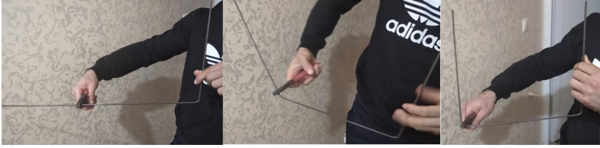
Şekil 5.1. Çelik telin pense ile bükümü
