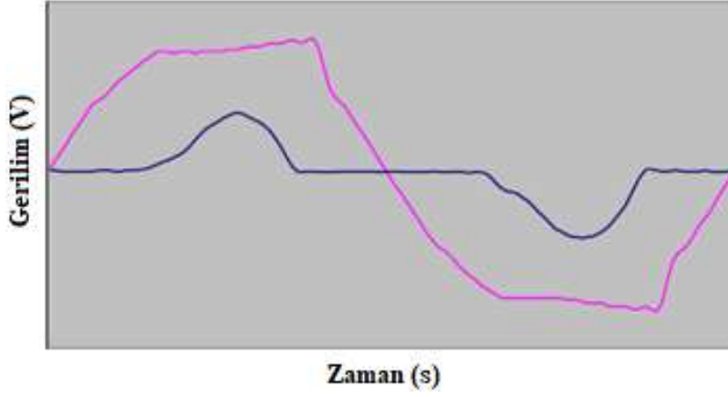
Şekil 2.17. Darbe akımları nedeniyle gerilim tepe düzleşmesi (ABS, 2006)
