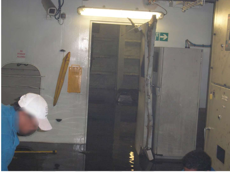
Resim 3.2. Kıç harmonik filtrede ve ana kumanda pano odasındaki su (MAIB, 2011)
