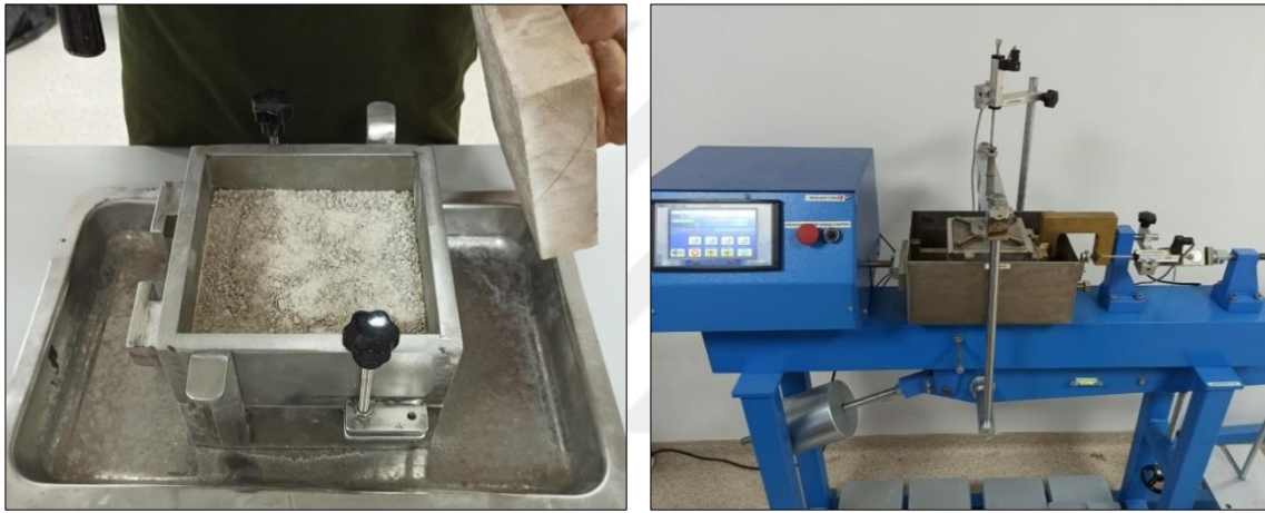
Resim 5.4. a) Kum zemin numunesinin kesme kutusuna yerleştirilmesi aşaması b) kesme kutusu deneyi uygulama aşaması
