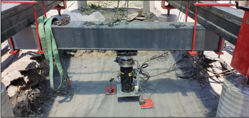
Resim 5.45. Yüklemenin kiriş ortasına ayarlanması
