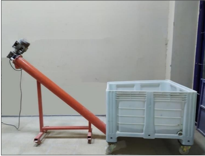
Resim 5.6. Zemin aktarma düzeneđi ve zemin depolama haznesi
