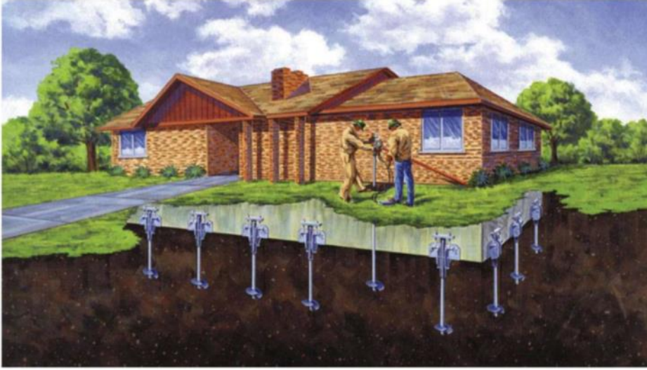
Şekil 2.17. Helisel kazıklar ile temel takviyesi uygulaması (Yılmaz, 2016)
