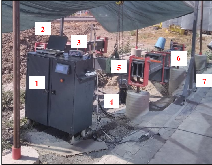
Resim 5.47. Deney ekipmanlarının genel görünümü 1) Yükleme kabini 2) Bilgisayar 3) Veri toplama ünitesi 4) Yükleme pistonu 5) Orta kiriş 6) Yan kiriş 7) Raylı vinç
