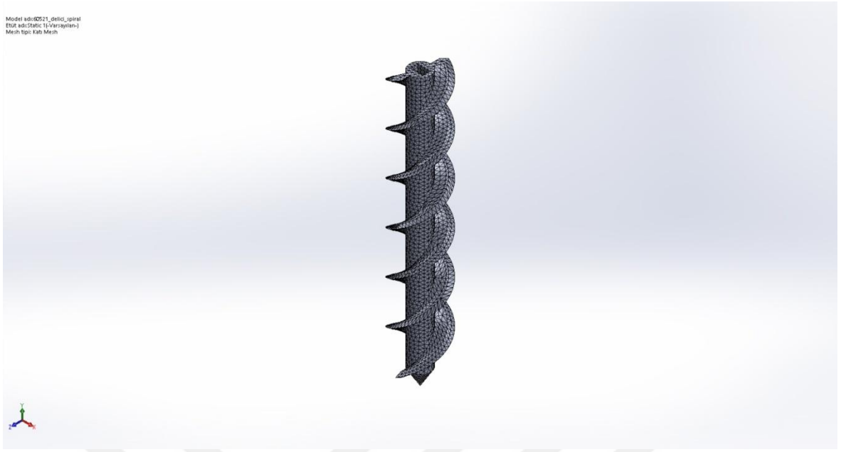
Şekil 2.24.Kazıcı spiral parçası mesh yapısı.
