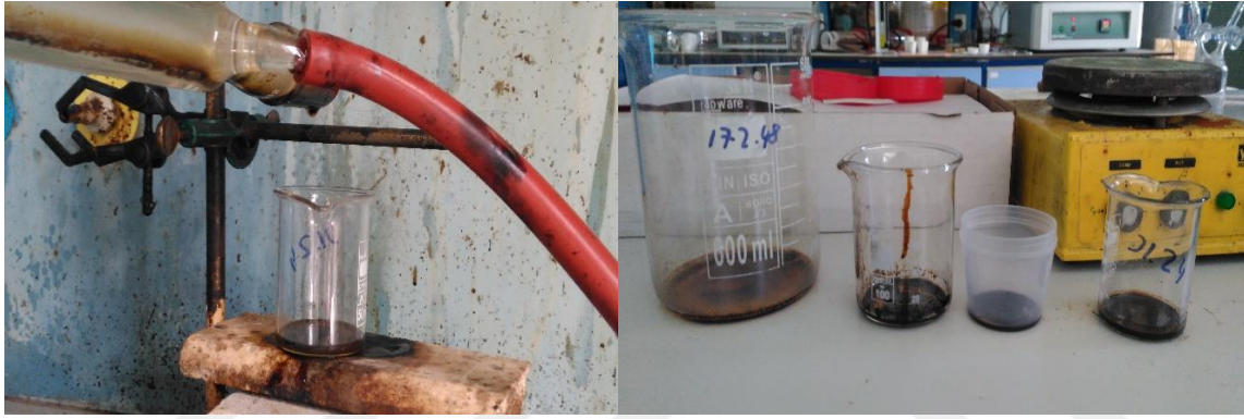
Resim 3.3. Karbonizasyon sırasında çıkan sıvı numuneler
