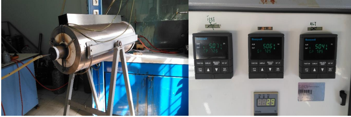
Resim 3.2. Karbonizasyon işleminin yapıldığı silindirik fırın
