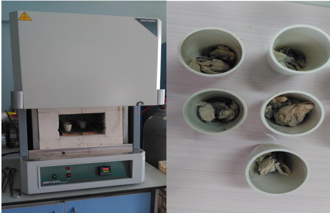
Resim 3.5. Kül tayinin yapıldığı fırın ve numuneler
