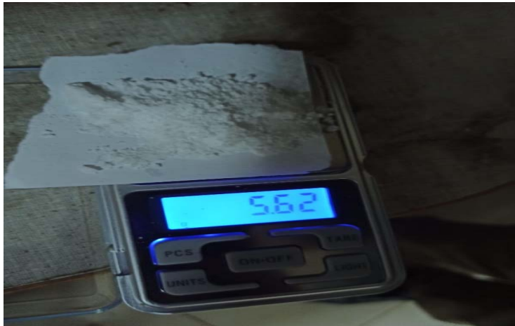
Resim 3.4. Farklı tuzluluk seviyelerine sahip deniz suyu için yapay deniz tuzu tartımı
