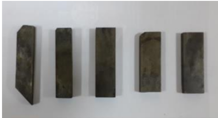
Şekil 5. 1000 °C'de 60 dakika süre ile borlanan numunelerin yüzey görünümü
