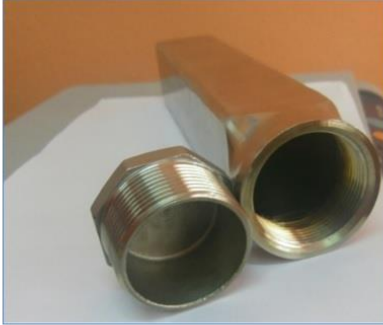
Şekil 4. Borlama işleminde kullanılan paslanmaz çelik pota
