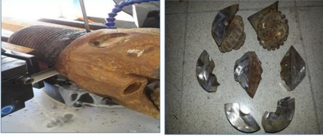
Şekil 3. Sondaj matkaplarının kaplama işlemleri için kesimi
