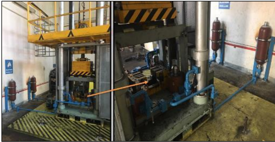
Resim 4.21 DWTT cihazı numune kırılma alanı
