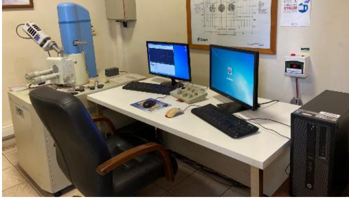
Resim 4.25 Taramalı elektron mikroskobu (jeol 6150)
