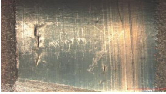
Resim 4.13 Mamul üzerinde çatlak
