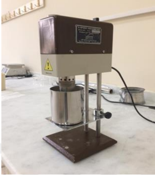
Resim 2.2. FANN model 8 hızlı döner viskozimetre [64]
