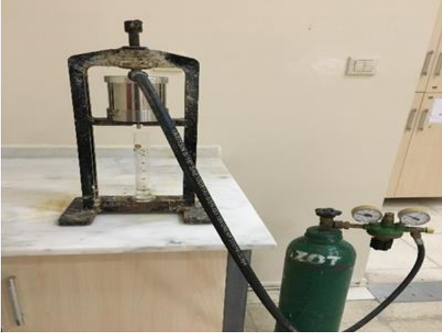
Resim 2.3. API filtre press [64]
