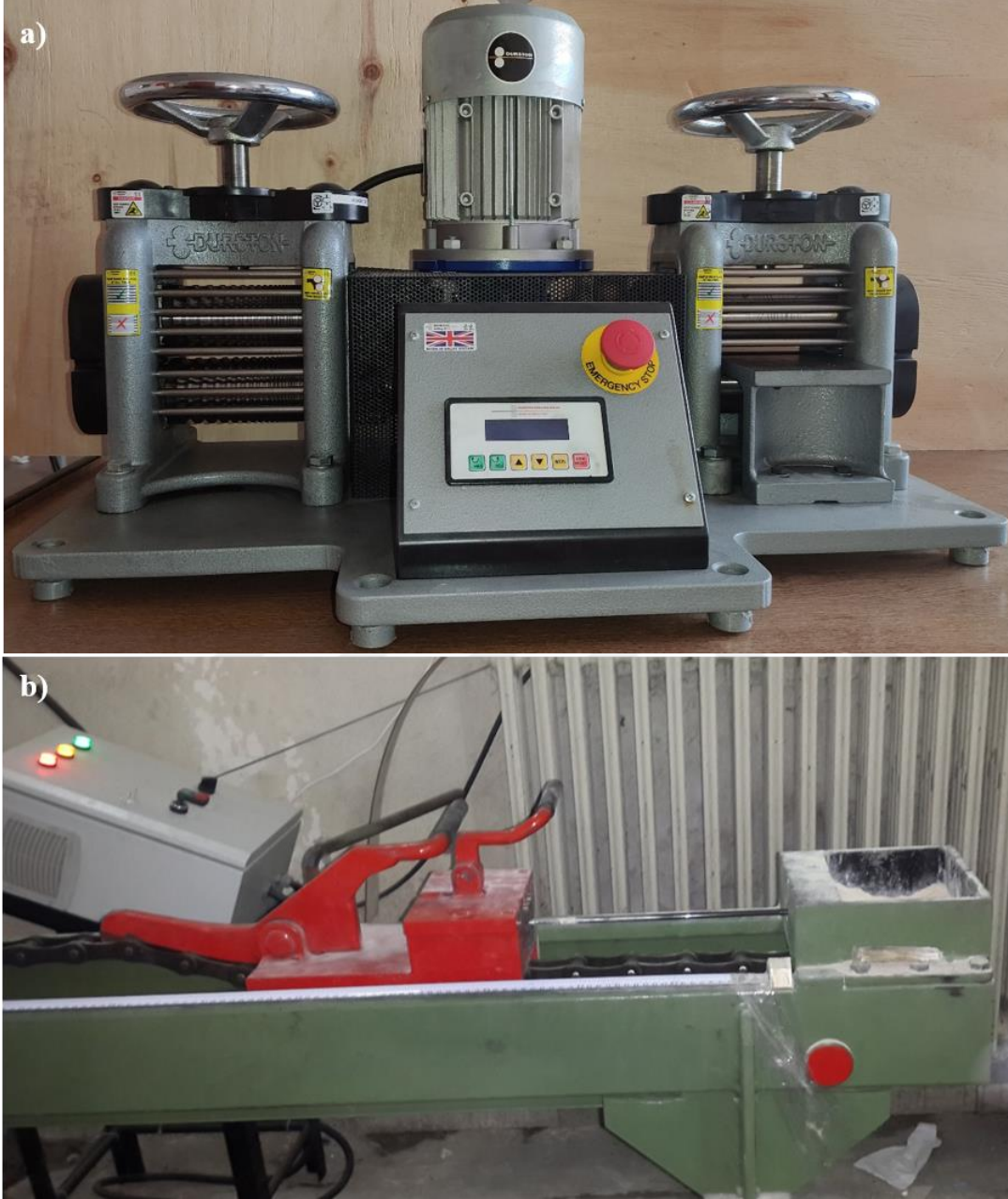
Resim 2.1. Powder in tube yönteminde kullanılan a) grove Rolling sistemi, b) die çekme sistemi
