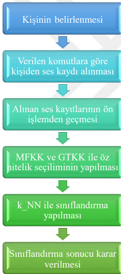
Şekil 4.1. Kişi bazlı kalibrasyon uygulaması akış diyagramı
