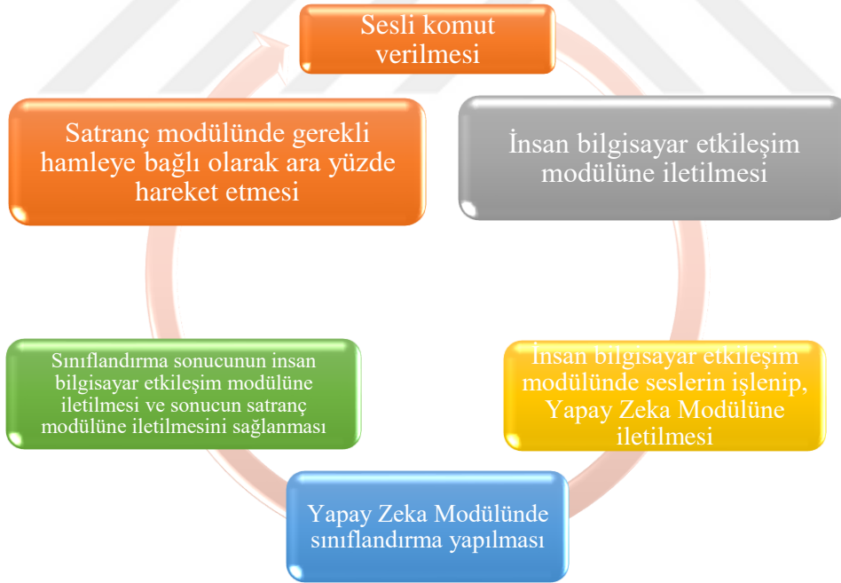
Şekil 3.6. Komut verildikten sonra sistemin iletişim diyagramı
