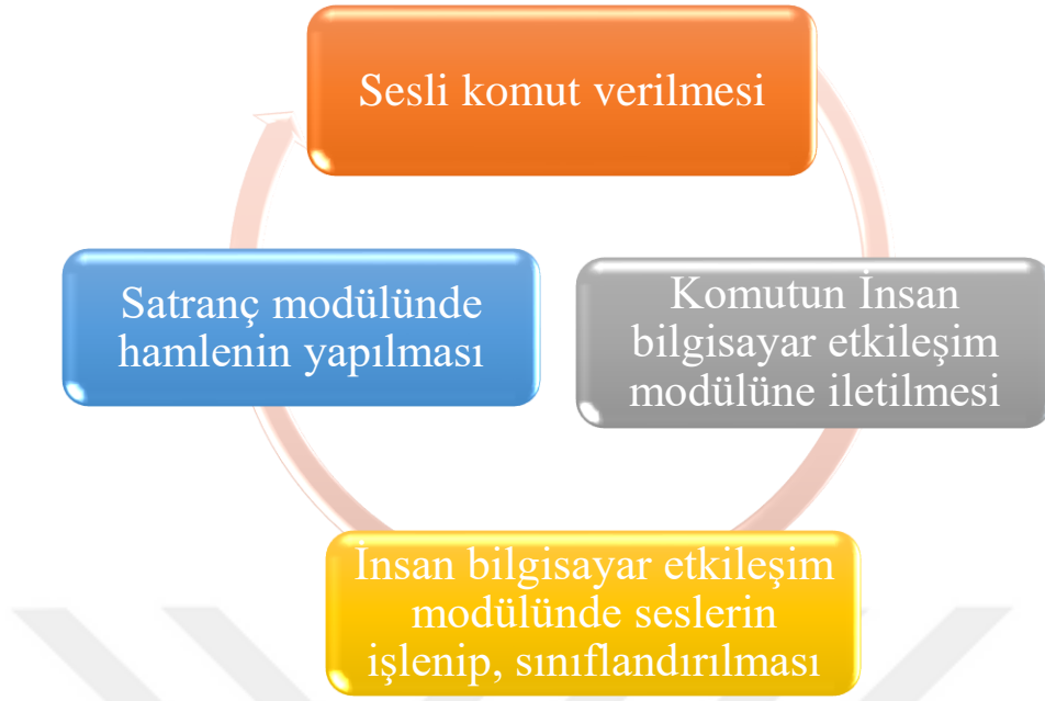
Şekil 3.5. Ses komutunun oyun üzerinde gerçekleştirilebilmesi için akış diyagramı
