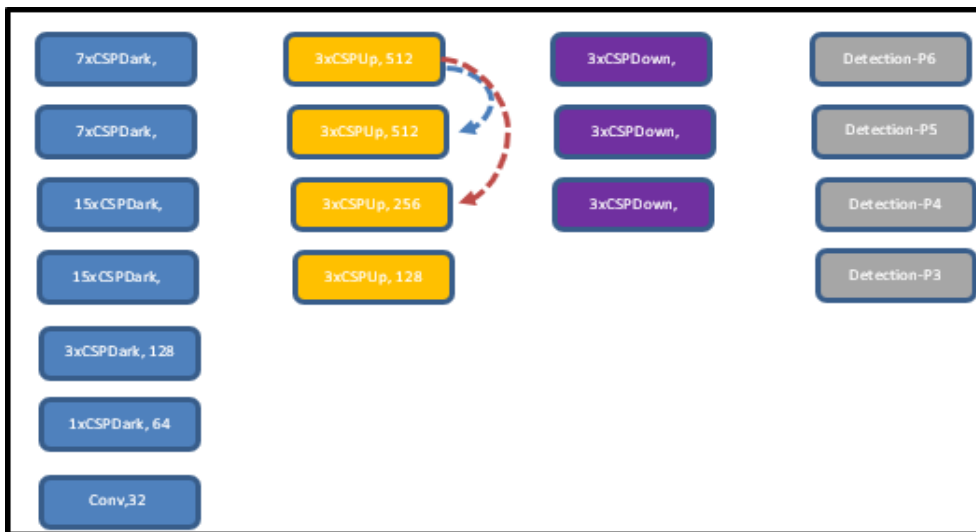
Şekil 4.10. YOLOv4-p6 mimarisi genel yapısı
