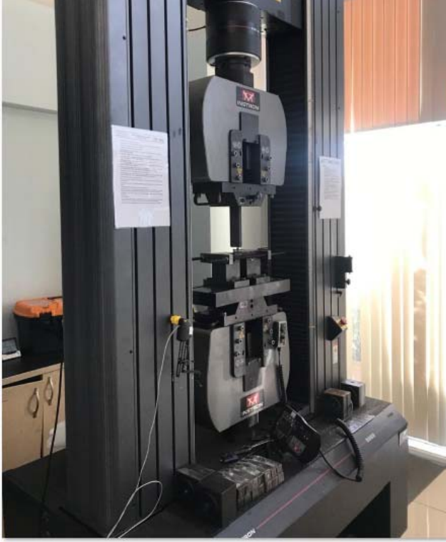
Şekil 3.17. Çekme ve eğme testinde kullanılan WEW 1000D marka cihaz.
