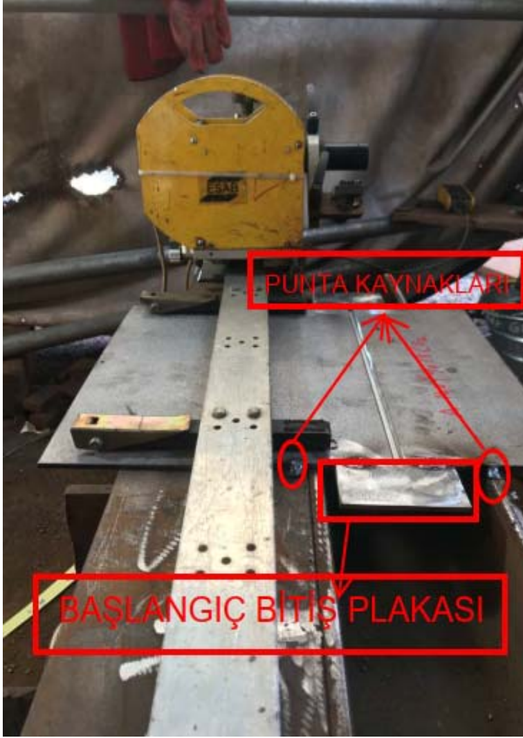
Şekil 3.4. Puntalama işlemine ait görsel
