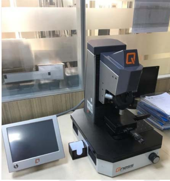
Şekil 3.13. Mikro sertlik ölçümünde kullanılan sertlik cihazı
