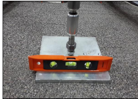
Şekil 6. Model temel plakasının yerleştirilmesi
