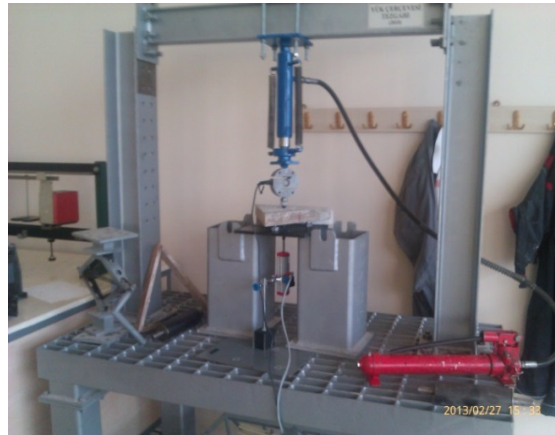
Şekil 2. Deney kurulumu ve üçgen plaka testinin şematik gösterimi (Schematic demonstrations of testing configuration and testing of a triangular plate)
