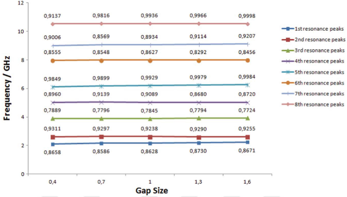
Şekil 4.7. Boşluk genişliğinin rezonans frekansı ve emilim değerleri üzerine etkileri
