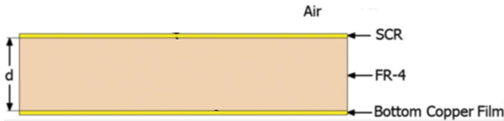
Şekil 4.14. SCR' lere sahip sinyal emici yapısının yandan görünüşü
