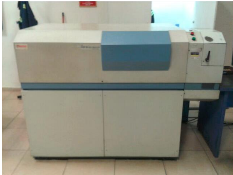
Şekil 3.22. Optik emisyon spektrometresi (ARL 4460 OES)
