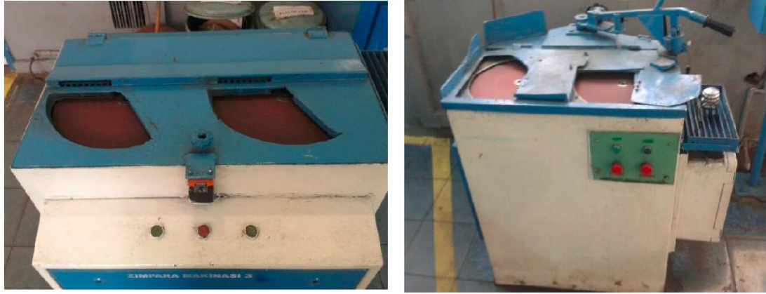
Şekil 3.21. Bant zımpara ve numune parlatma cihazı
