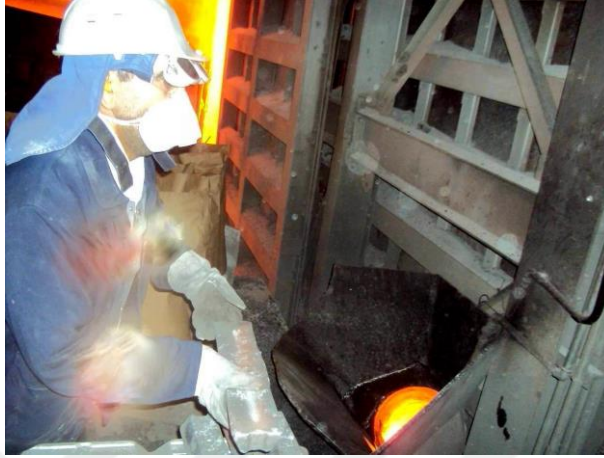
Şekil 4.3. Manuel külçe al besleme prosesi
