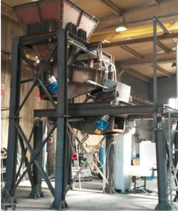
Şekil 4.1. Prototip külçe alüminyum besleme sistemi
