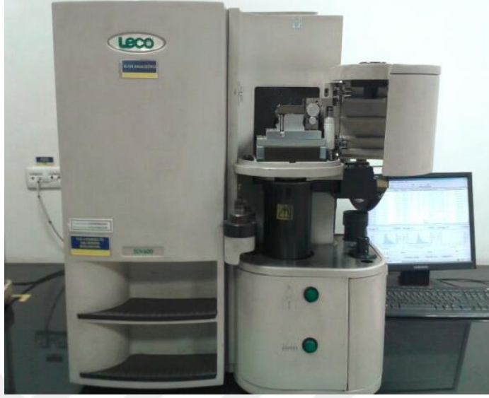
Şekil 3.23. N-O cihazı Leco THC600
