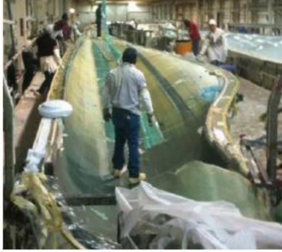
Şekil 3.26. İnfüzyon İşlemi Bitirilmiş Kanat Yüzeyi
