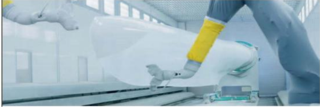
Şekil 3.31. Robot Kollar İle Kanat Yüzeyine Boya Uygulanması
