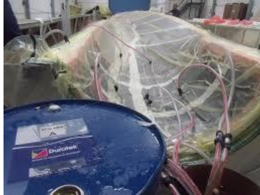
Şekil 3.25. Infüzyon İşlemi Öncesi Vakumlanmış Parça (Anonim, 2014)
