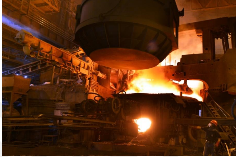
Şekil 3.3. EAO'na hurda şarjının yapılması
