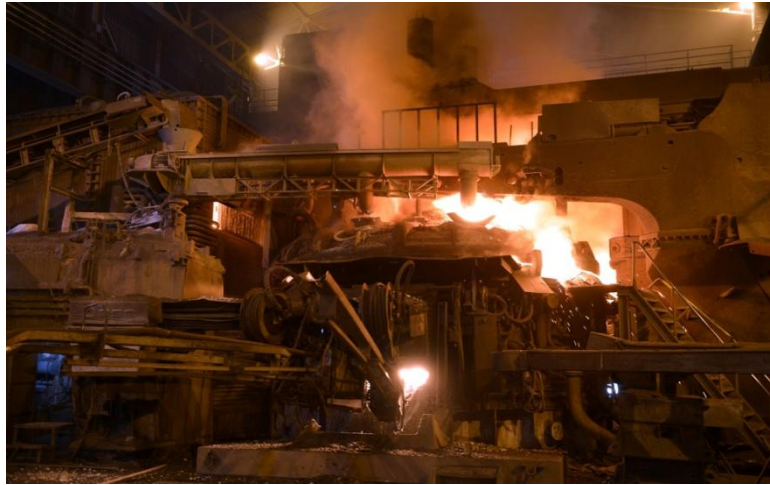
Şekil 3.1. Elektrik ark ocağı genel görünümü
