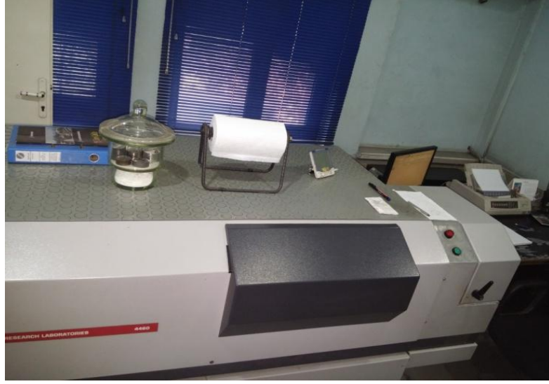
Şekil 3.14. Optik emisyon spektrometresi (ARL 4460 OES)
