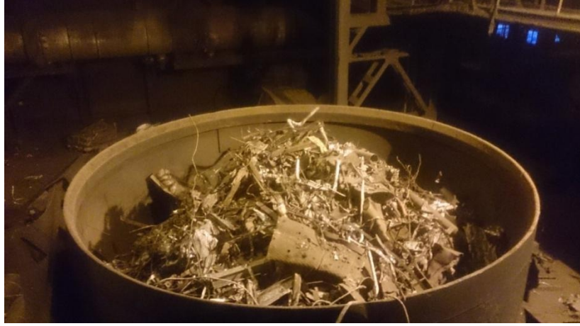
Şekil 3.11. Kireç eklenmiş hurda sepeti (2. Hurda Şarjı)
