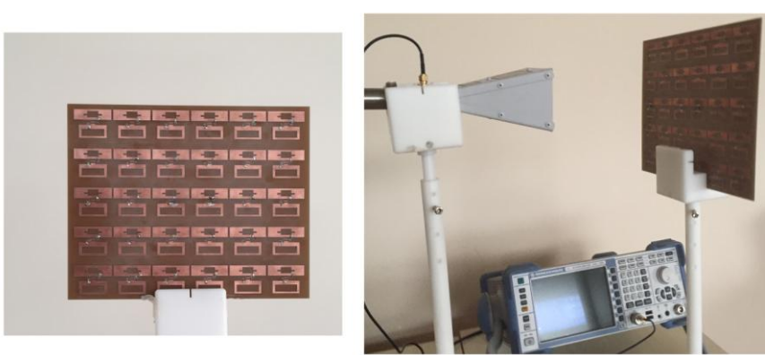
Şekil 4.46. Üretilen 5x6 yapı ve ölçüm düzeneği
