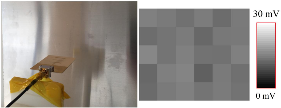
Şekil 4.53. Arada metal plaka bulunması durumunda yagi uda antenli ölçüm
