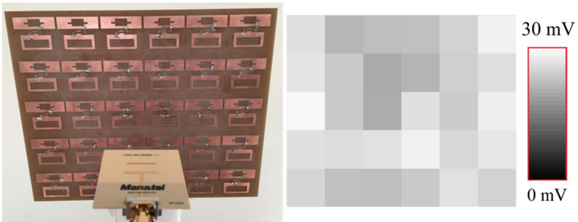
Şekil 4.52. 5,80GHz yagi uda anten ile yapılan ölçüm ve elde edilen görüntü
