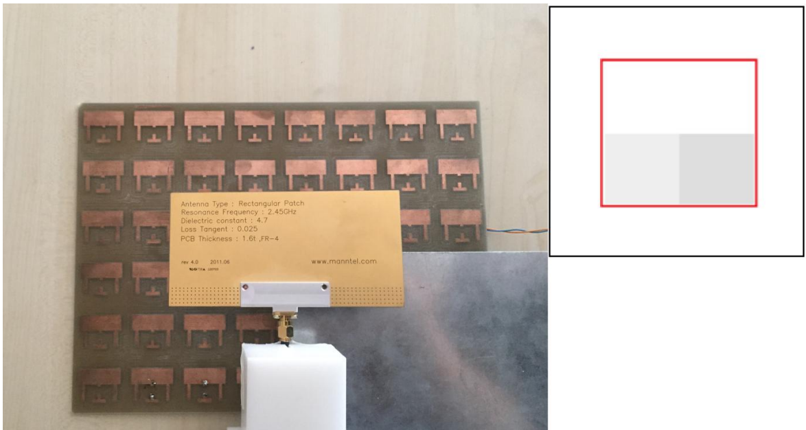
Şekil 4.25. Bir kısmı metal ile kapatılmış yapı sinyal altındayken ve piksel yapısı
