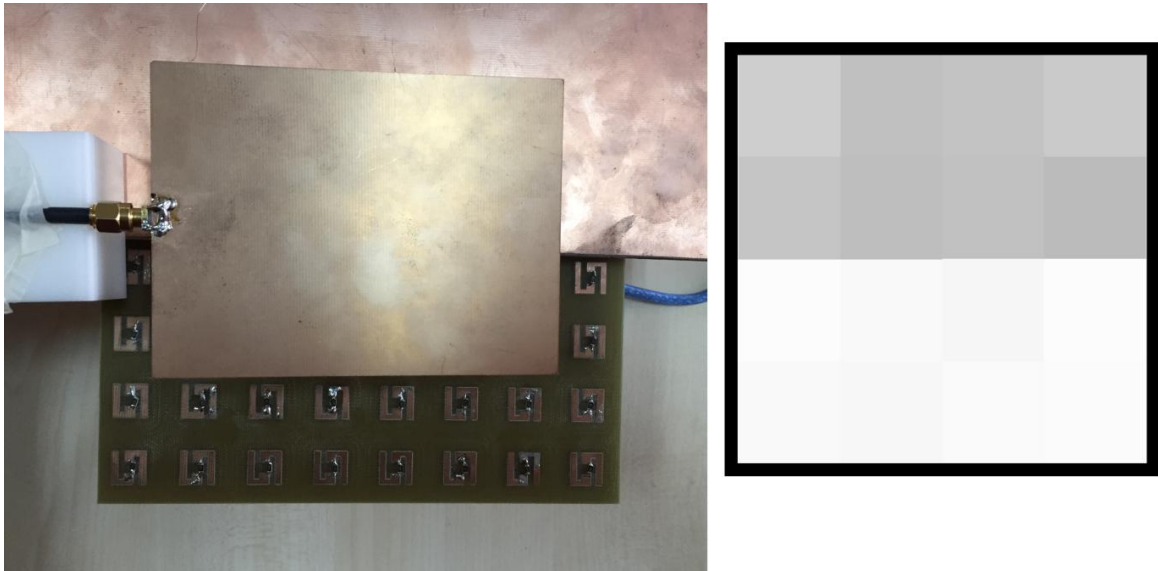
Şekil 4.41. Metal plaka yerleştirilmiş deney düzeneği ve elde edilen görüntü
