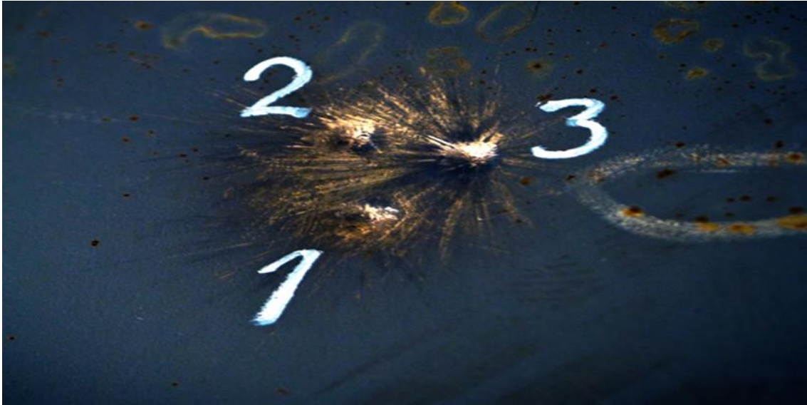
Resim 2.2. ARMOX serisi zırh çeliğinin mermilere karşı gösterdiği balistik dayanımlar (SSAB, 2018)
