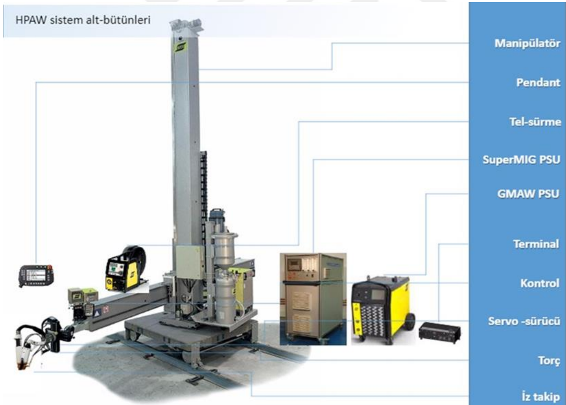
Resim 2.11. Hibrit plazma ark kaynak makinesi ünitesi (ODTÜ KTTMM, 2018)
