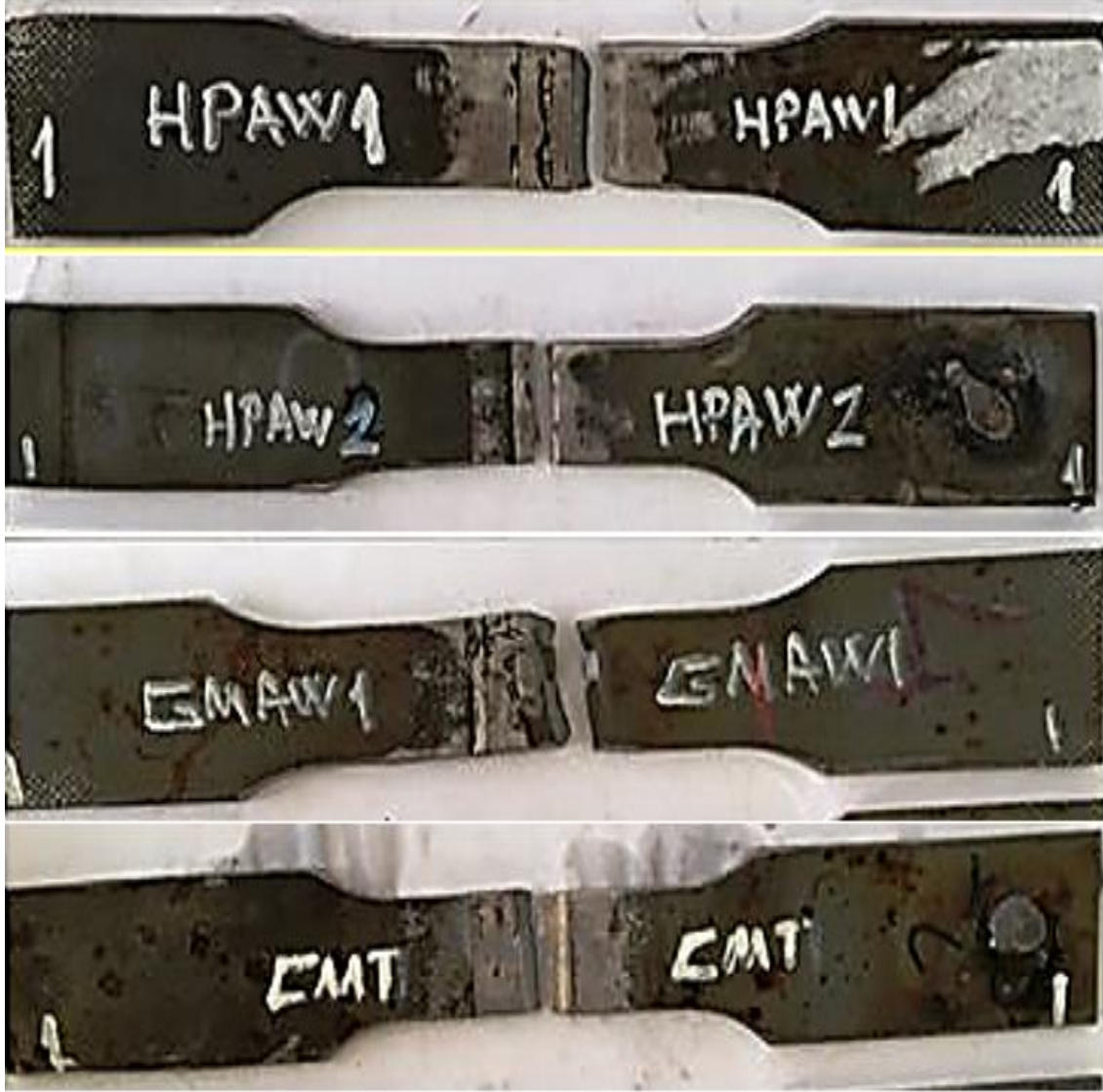
Resim 3.28. Çekme sonrası kaynak yöntemlerine ait kırılma görüntüleri
