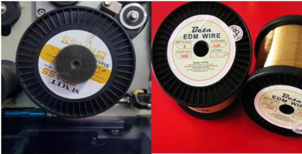
Resim 3.2. Çalışmada kullanılan pirinç tel elektrotlar.
