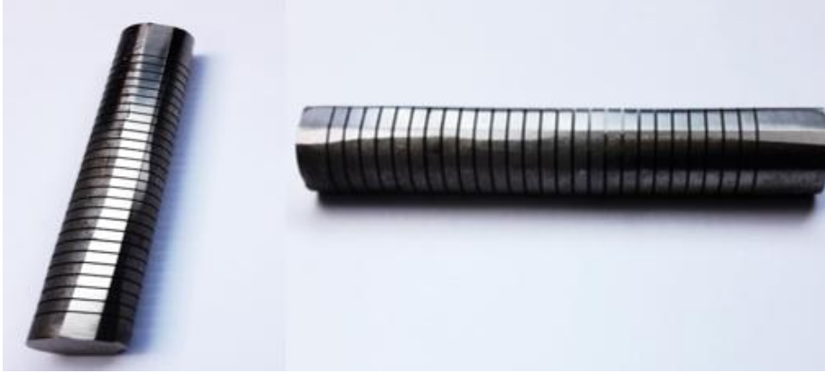
Resim 3.3. Tel erozyon yöntemi ile kesilen numune görünüşleri.
