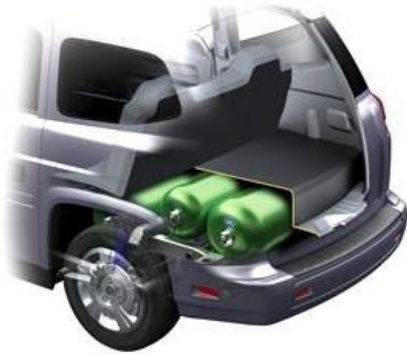
Şekil 1.4. Doğal gazlı aracın depolama tankı (Gigaom, 2015)
