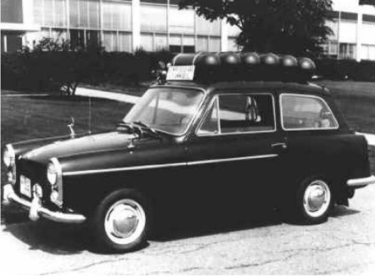
Şekil 1.7. 1970 yılında K. Kordesh tarafından yaptırılan kamuya açık yollarda hidrojenle çalışan yakıt hücresi yolcu aracı (Kordesch ve diğerleri, 1999)
