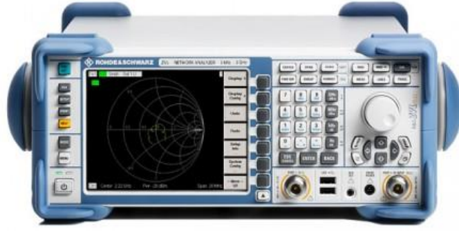
Şekil 3.2. Ölçümlerde kullanılan vektör network analizör cihazı
