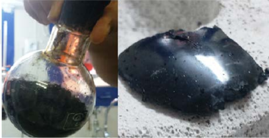
Şekil 3.5. Ön iyileştirme işlemi neticesinde geriye kalan katı kalıntı (kok)
