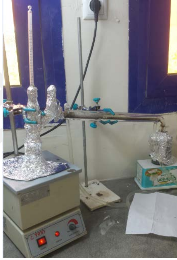
Şekil 3.3. Ağır ham petrolün ön iyileştirme işlemi
